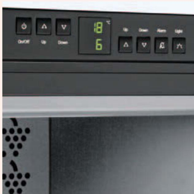
Die präzise **elektronische Steuerung** ist mit einer digitalen Temperatur-Anzeige ausgestattet. Die Temperaturen lassen sich im unteren Bereich zwischen +5°C und +7°C, im oberen Bereich zwischen +16°C und +18°C einstellen, dazwischen ergibt sich eine Temperaturschichtung.
